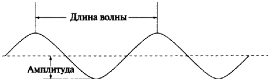
Рис. 4.2. Длина волны определяется как расстояние между соседними максимумами или минимумами. Амплитуда представляет собой наибольшую высоту или глубину волны
